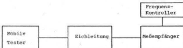
Prüfung: Die Eichleitung auf 112 dB Dämpfung einstellen. Am Meßempfänger die Frequenz 131 MHz, den Bereich 3 mV und die Bandbreite 15 kHz einstellen. Anschließend wird der Pegel bei folgenden Einstellungen kontrolliert:
